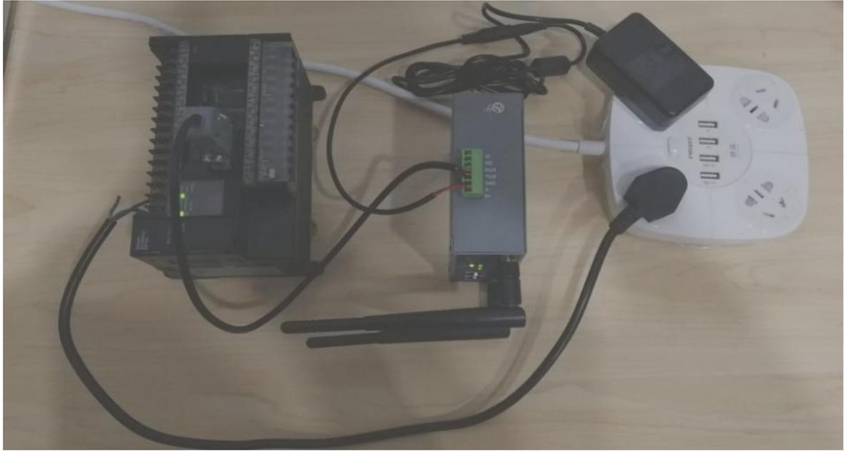
Superlink 网关和欧姆龙 CP1H 串口 PLC 连接示意图
